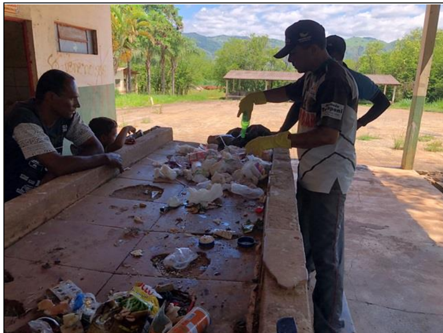
Figura 7 – Andamento do ensaio: segregação dos componentes Fonte: Premier Engenharia, 2024.
